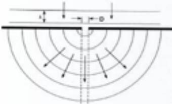
Wellen breiten sich nach dem Passieren einer Öffnung ( $D$ ), die wesentlich kleiner als die Wellenlänge ( $\lambda$ ) ist, gleichmäßig in alle Richtungen aus.
