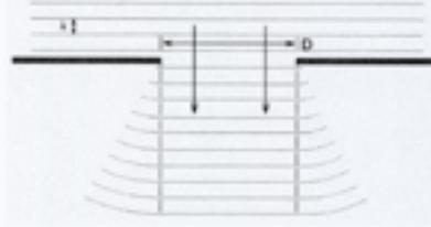
Bei sehr großer Öffnung ( $D$ ) im Vergleich zur Wellenlänge ( $\lambda$ ) ist der Wellenaustritt hauptsächlich in ursprünglicher Richtung begrenzt.
